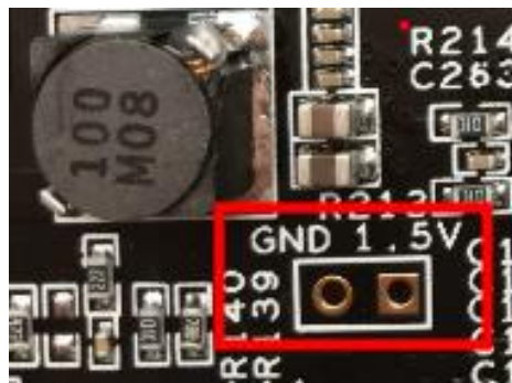
图 2.2 实物图中的电源测试点
